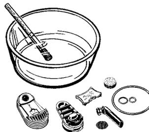
Nettoyage manuel de l'Unité de Refroidissement démontée
